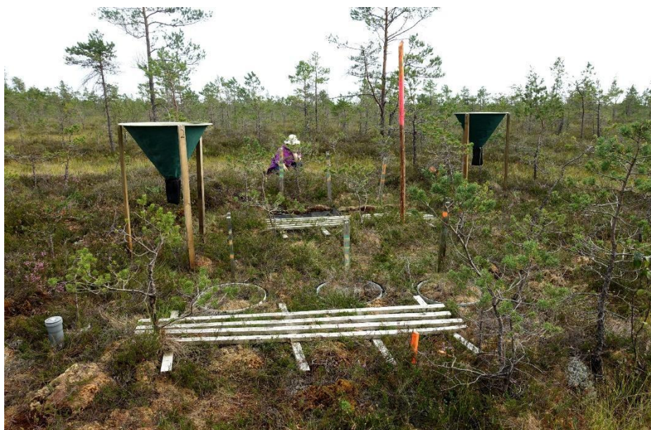
6.1. attēls. Ekosistēmas emisiju mērīšanas parauglaukums un kokaugu nobiru savācēji DL “Lielais Pelečāres purvs”. Foto L. Strazdiņa
