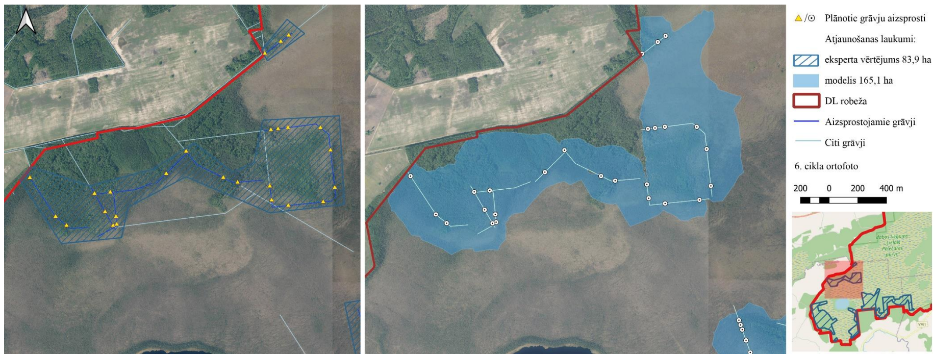
7.10. attēls. Atjaunošanas laukumu 4. Astesmeža grāvji un 5. Borovkas grāvis shēmas (pa kreisi) un hidroģeoloģiskais modelis (pa labi)
