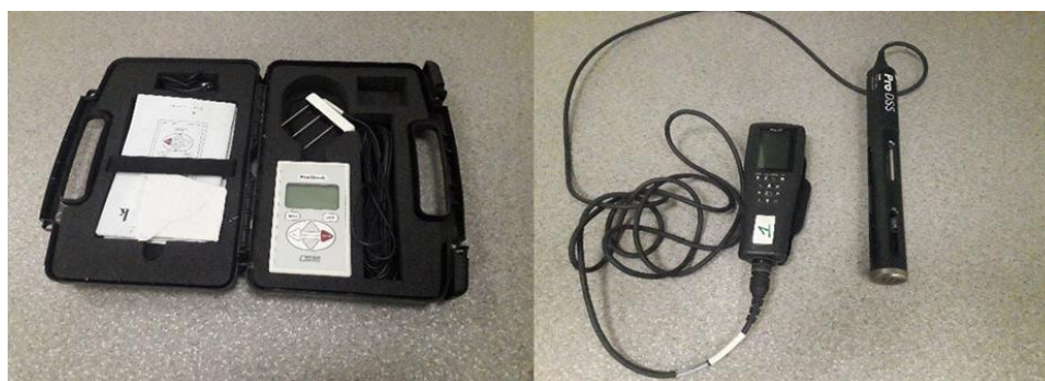
6.2. attēls. Iekārtas augsnes temperatūras, mitruma satura un gruntsūdens īpašību mērīšanai.
