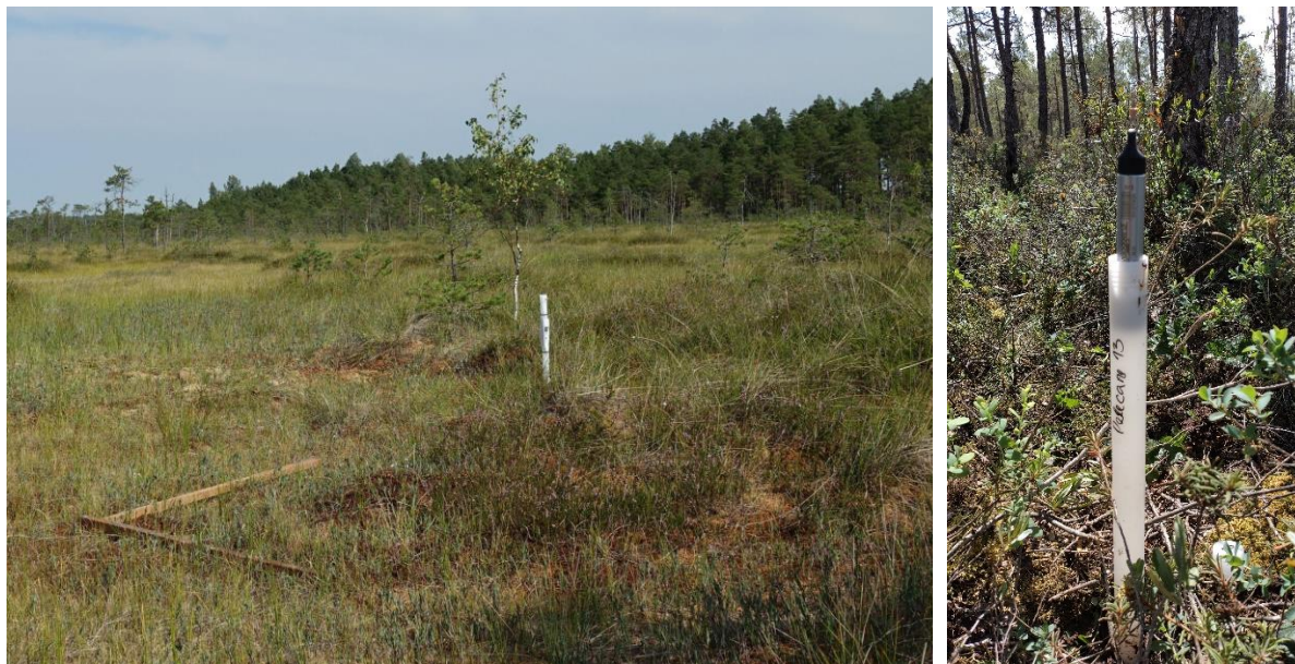
4.5. attēls. Ūdens līmeņa mērījumu monitoringa urbums DL “Lielais Pelečāres purvs”, kas aprīkots ar automātisko ūdens līmeņa zondi. Foto: L. Strazdiņa, A. Kalvāns
