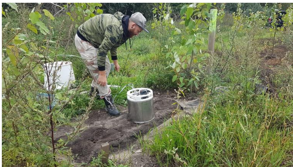
6.3. attēls. Augsnes elpošanas mērīšana. Foto: M. Vanags-Duka
